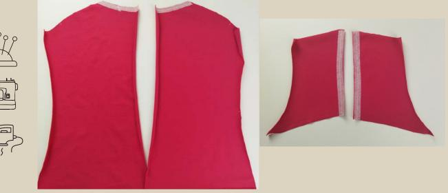
Проклеить с изнаночной стороны косой клеевой нитепрошивной кромкой линию горловины на деталях переда (верхней и нижней части), а также линию горловины на детали спинки.
