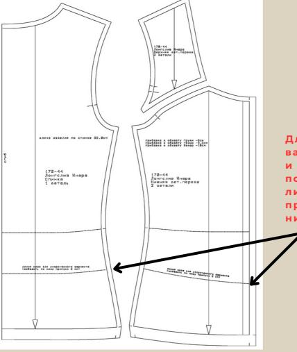
Для укороченного варианта детали спинки и низ переда выкроить по нижним пунктирным линиям, добавив припуски на подгибку низа по 2 см.
