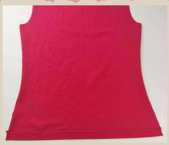
Закрепить припуски подгибки низа на деталях переда, спинки и рукавов строчкой на распошивальной машине, используя широкий двух игольный шов (можно заменить на строчку двойной иглой на швейной машине).
