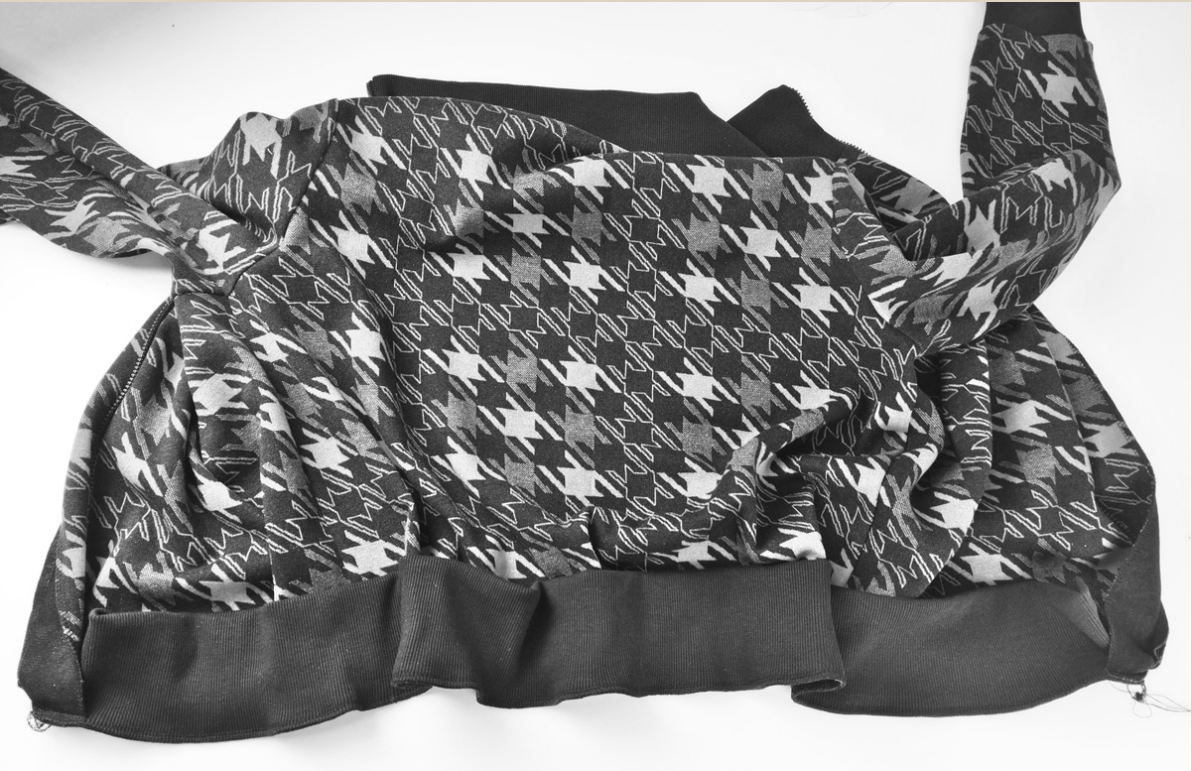
78. Стачать детали на оверлоке, равномерно растягивая манжету низа, но не растягивая низ толстовки.
