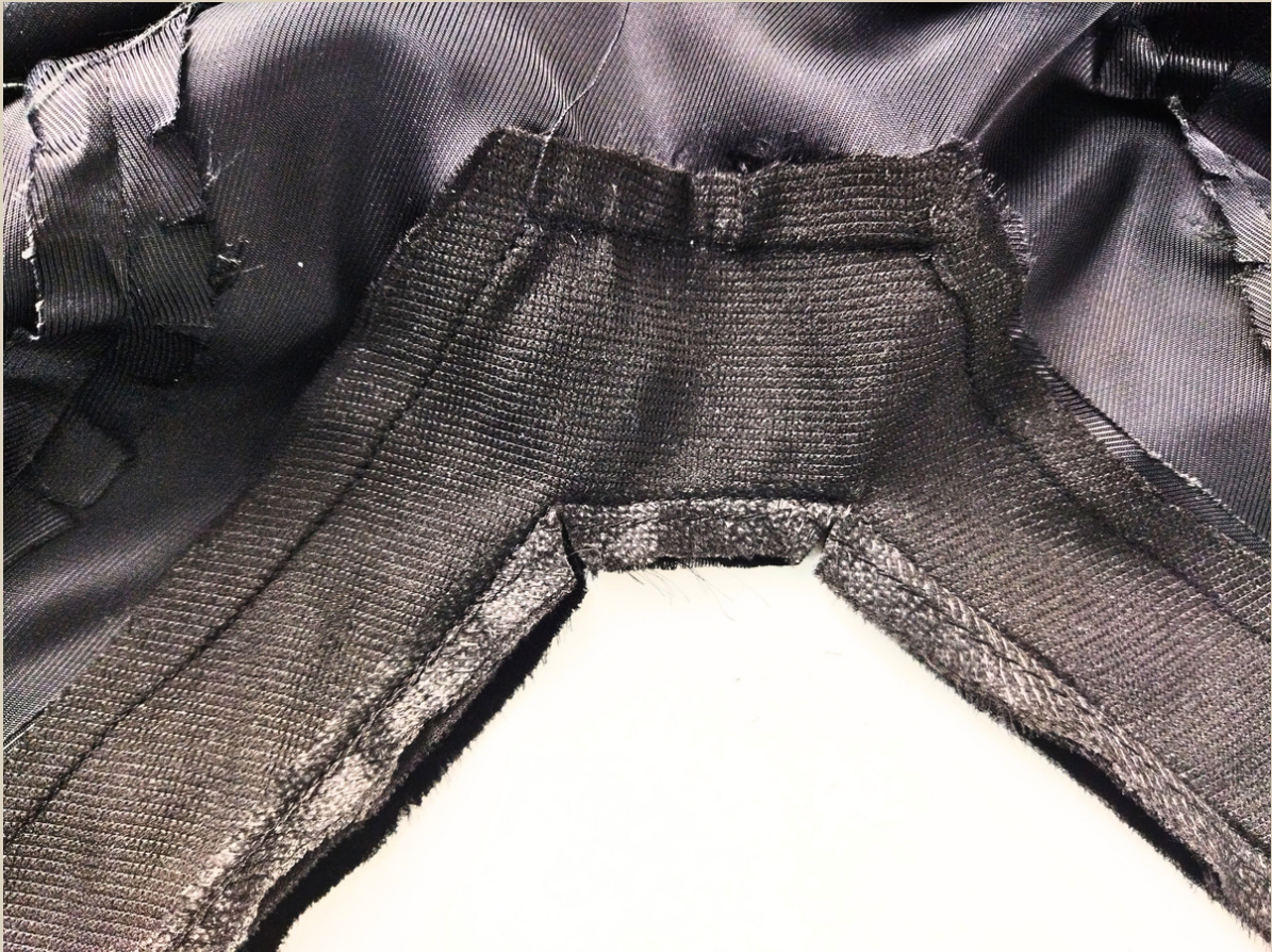
52. Припуски в уголках рассечь, не дорезая до строчки 2 мм.
