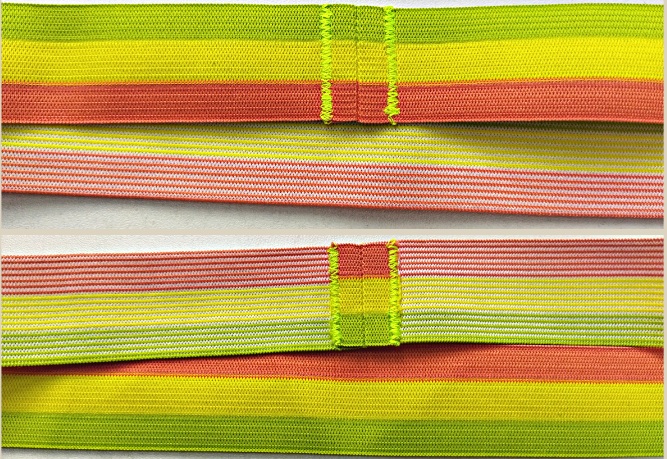
16. Припуски закрепить на швейной машине, используя строчку мелкий частый зигзаг вперед-назад несколько раз. Швы приутюжить.
