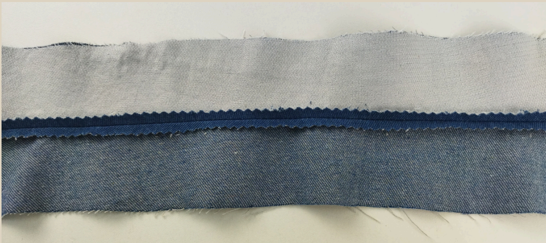
111. Припуск разутюжить в разные стороны.
