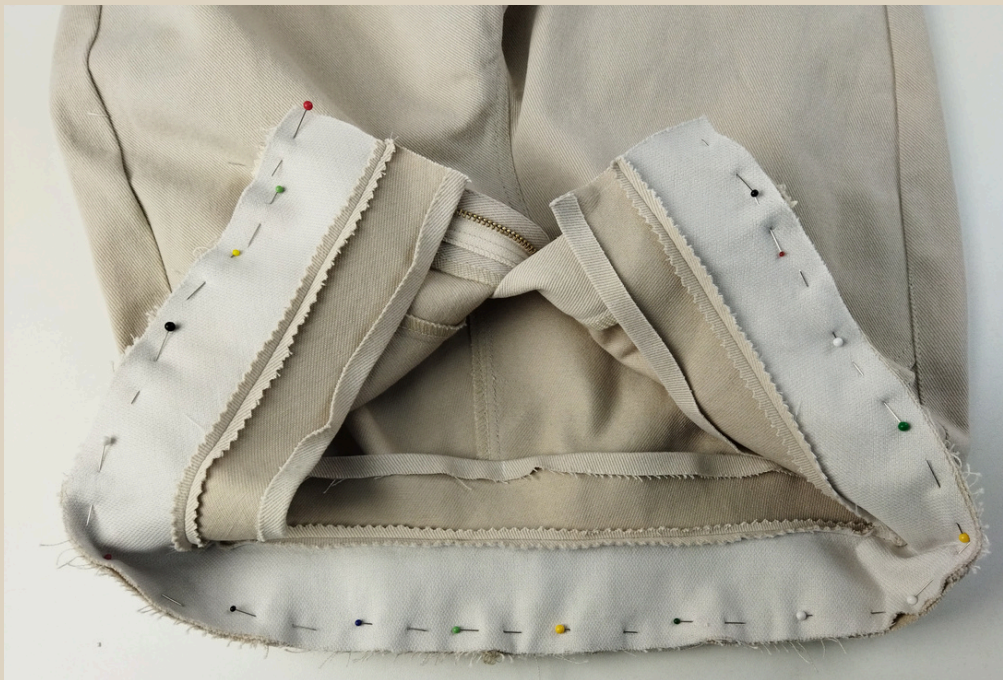
113. Приколоть пояс к изделию, прикладывая внутреннюю часть пояса к изнаночной стороне джинс, совмещая все метки. Боковые припуски пояса оставить свободными.
