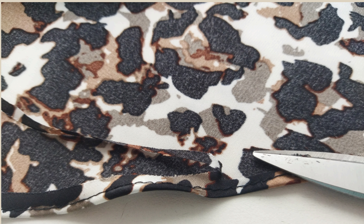
47. Срезать припуск ножницами, оставляя от строчки 2 мм.
