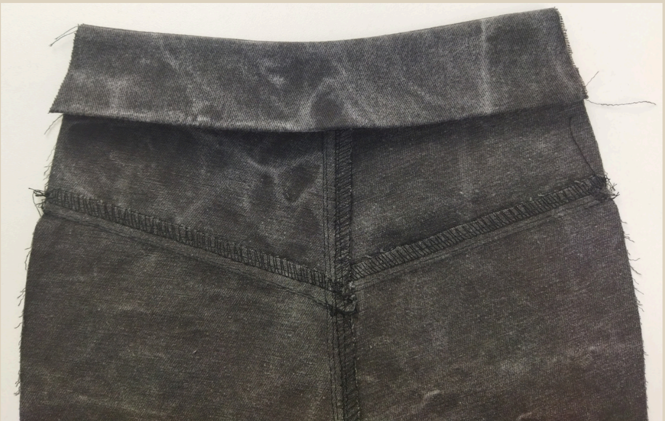
70. Сложить пояс, как на фото, перекрывая шов притачивания сгибом внутренней части пояса.
