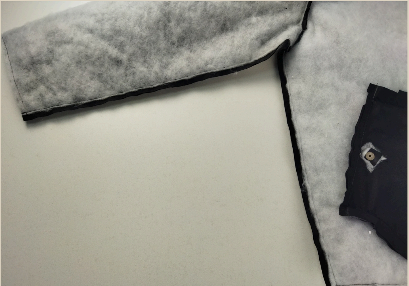
88. Утеплитель с припусков высечь.
