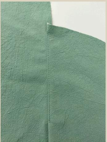
5. Настрочить припуск на швейной машине на сторону подкладки кармана. Ширина шва 1-2 мм.
