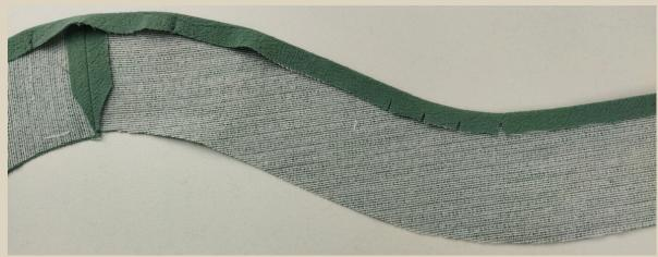
56. По вогнутой части припуска сделать рассечки, не дорезая до линии сгиба 2-3 мм.
