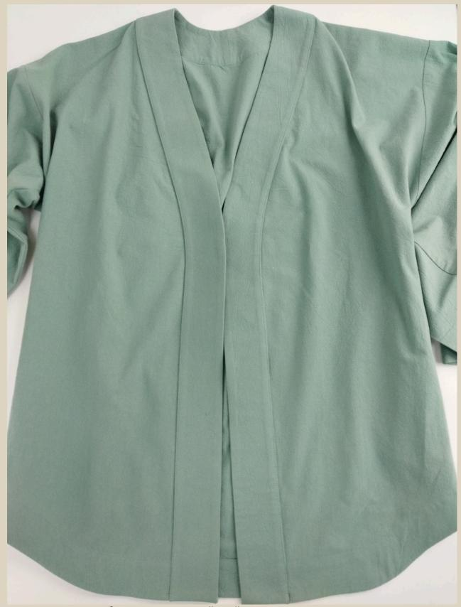
83. Притачать обтачку на швейной машине. Ширина шва 1 мм.
