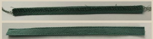
95. По длинным сторонам шлевки проложить строчки на швейной машине. Ширина швов 1,5-2 мм.96. Швы приутюжить.
