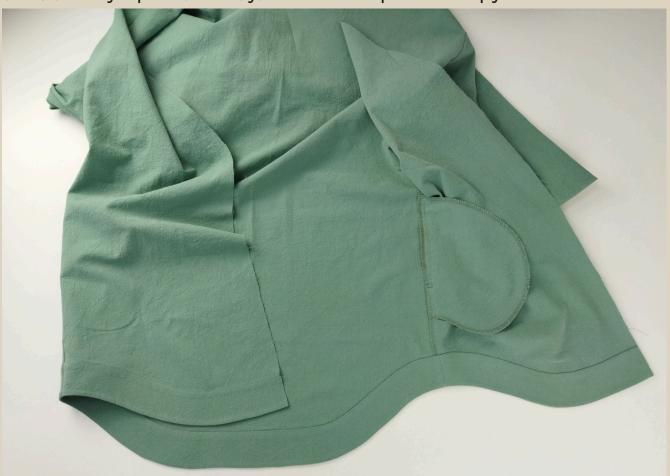
63. Притачать обтачку низа строчкой на швейной машине. Ширина шва 1 мм.
