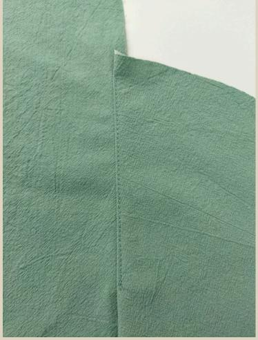
10. Припуски заутюжить и настрочить на швейной машине на сторону подкладки карманов от метки до метки входа в карман.
