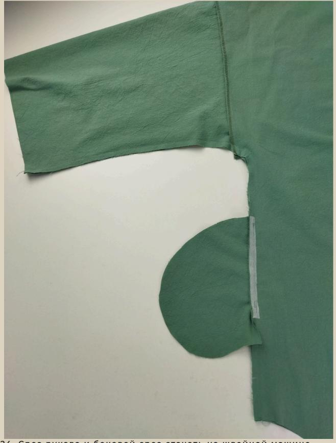
24. Срез рукава и боковой срез стачать на швейной машине. Боковой срез стачать до верхней метки входа в карман и от нижней метки входа в карман до низа изделия.
