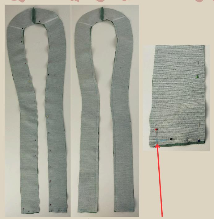
70. Две подготовленные обтачки сложить лицом к лицу, сколоть булавками по внутреннему срезу. По низу обтачки сколоть, как на фото (до линии стачивания).
