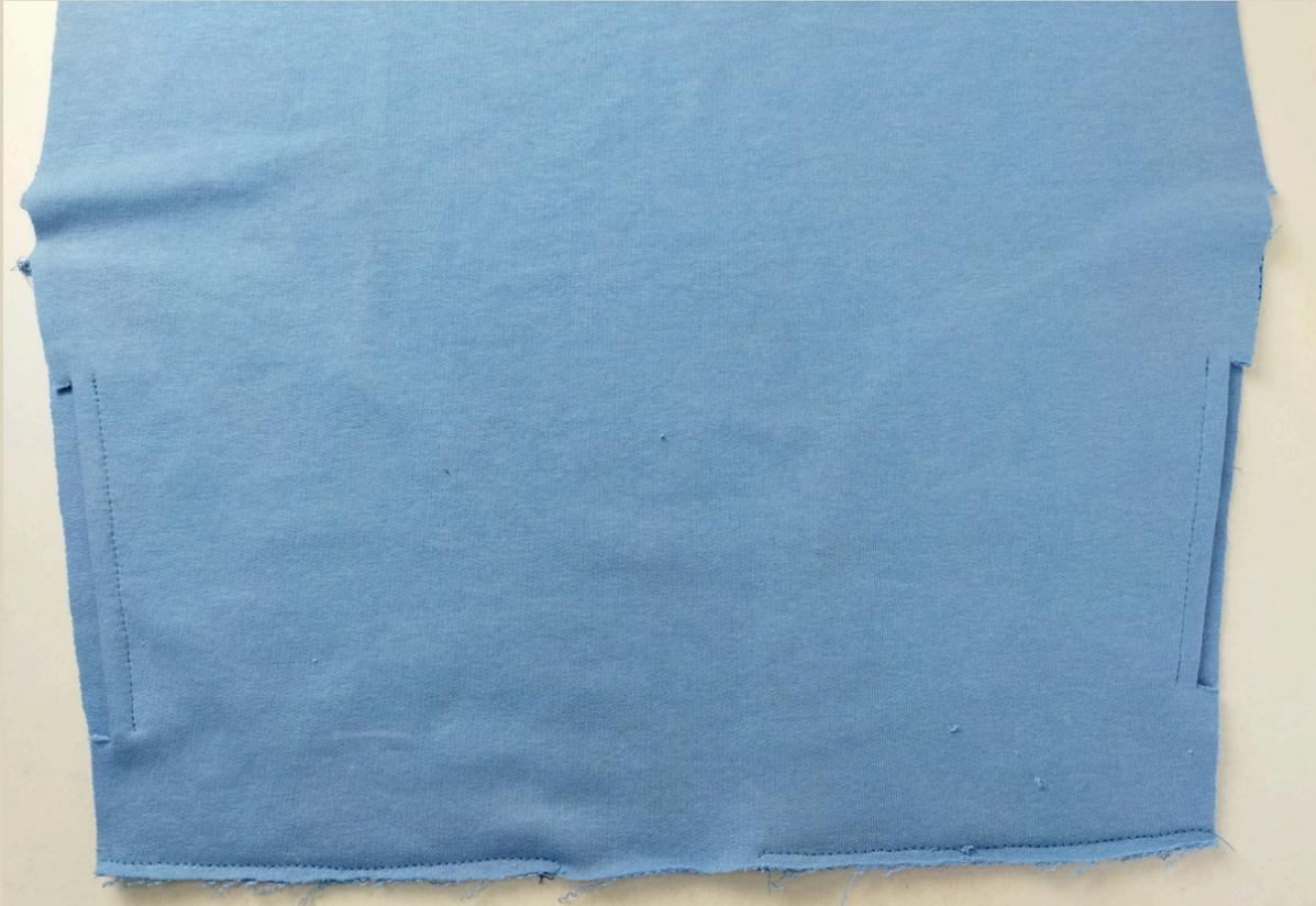
34. Закрепить мешковины карманов к переду строчкой на швейной машине. Ширина швов 5 мм.
