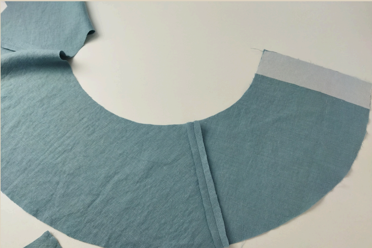
18. Припуски разутюжить в разные стороны.
