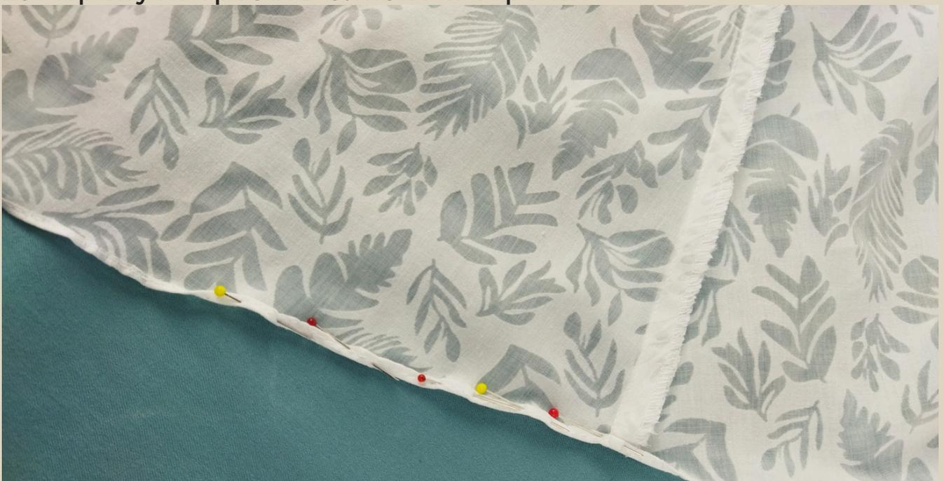
30. Припуск подогнуть на изнаночную сторону на 0,3 см и заколоть булавками, можно заметать ручными стежками.
