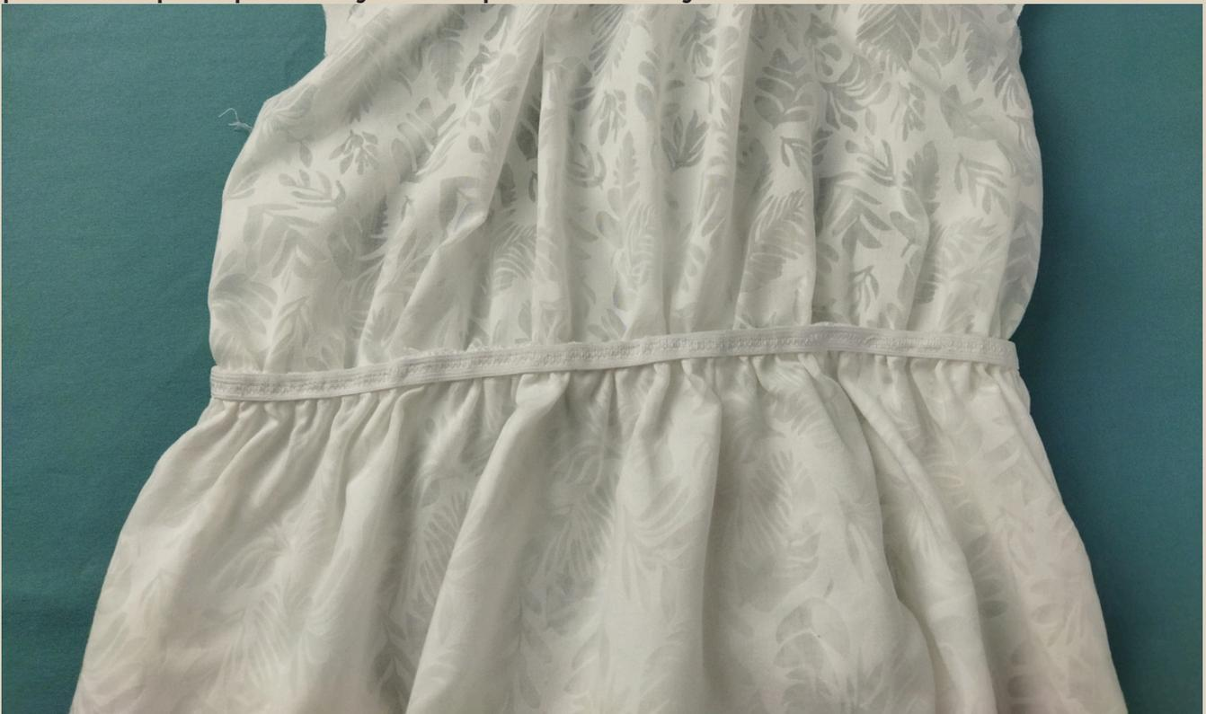
**74. Притачать резинку на припуск на швейной машине с помощью строчки зигзаг или ступенчатый зигзаг.**
