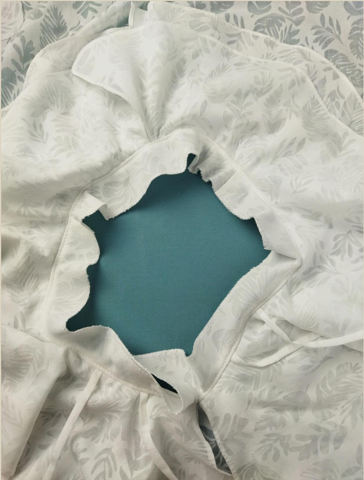
58. Припуск заутюжить на сторону обтачки и настрочить на швейной машине. Ширина шва 2 мм.
