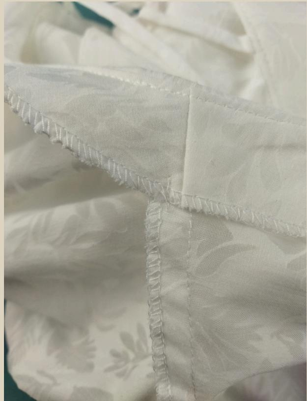
93. Обтачку горловины закрепить к платью по плечевым швам ручными закрепками или закрепками на швейной машине.
