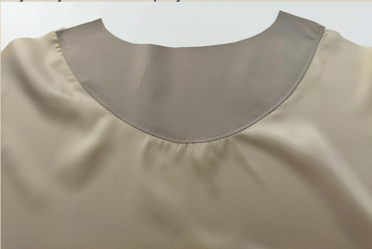
6. Настрочить припуск на сторону обтачки на швейной машине. Ширина шва 2 мм.
