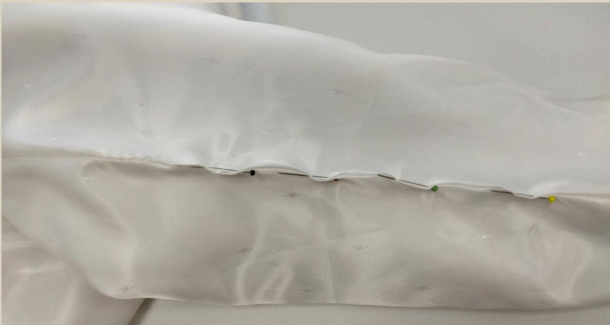
161. Техническое отверстие в рукаве подкладки зашить ручными потайными стежками или строчкой на швейной машине. Ширина шва 1-1,5 мм.
