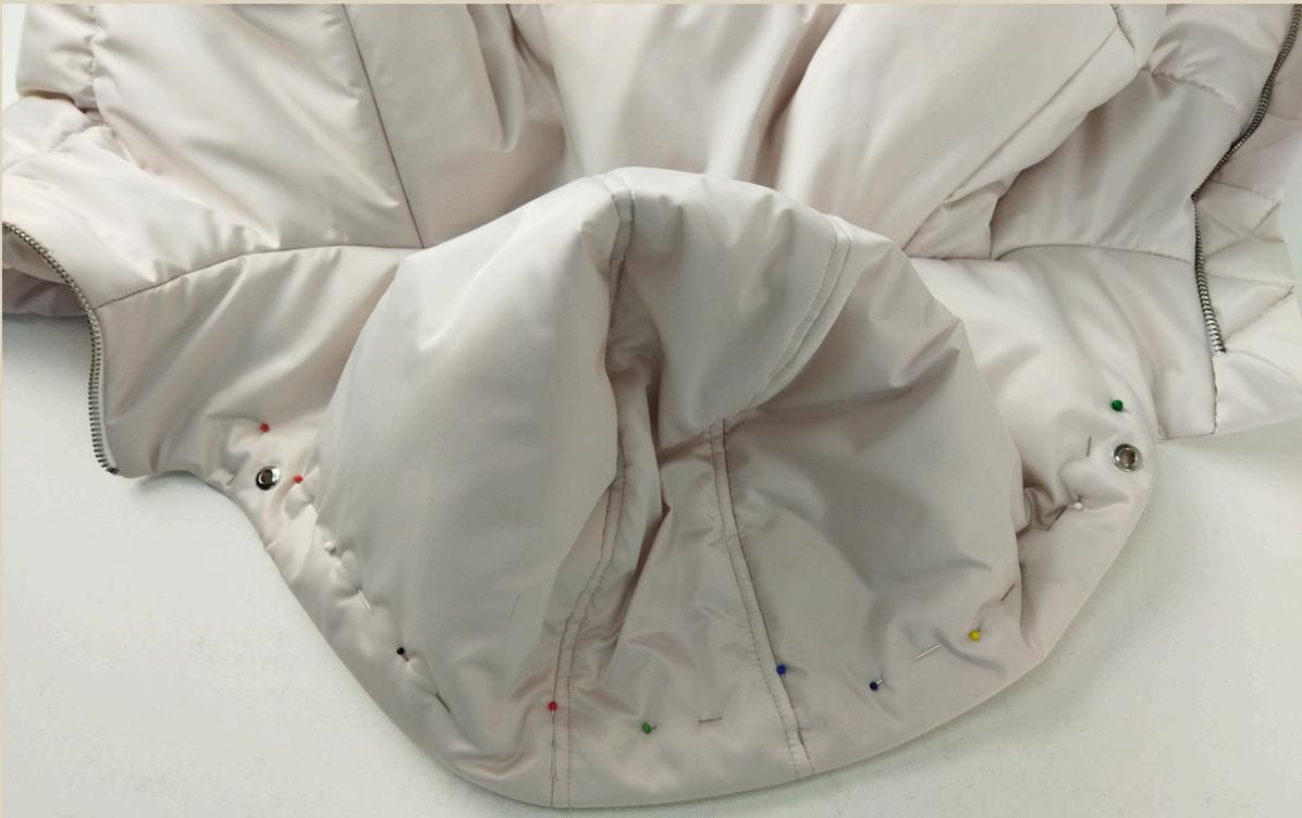
158. Край капюшона сколоть булавками, булавки вколоть строго по той линии, где будет проходить строчка на швейной машине.
