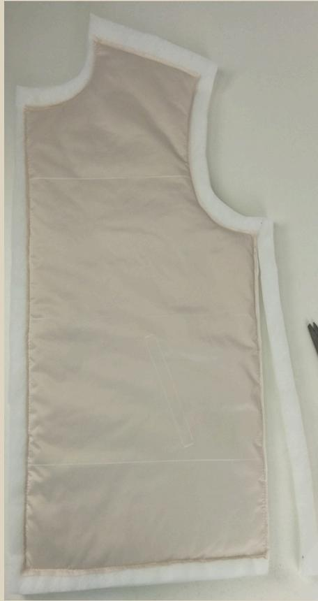
54. Детали из курточной ткани наложить на детали из утеплителя, наколоть детали булавками по периметру.
