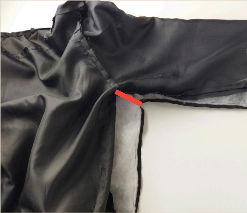
151. Куртку и подкладку закрепить между собой мостиками (полосками) из ткани (5 на 1 см) по низу проймы и по плечевому шву. Один конец мостика притачать к припуску куртки, второй к припуску подкладки.
