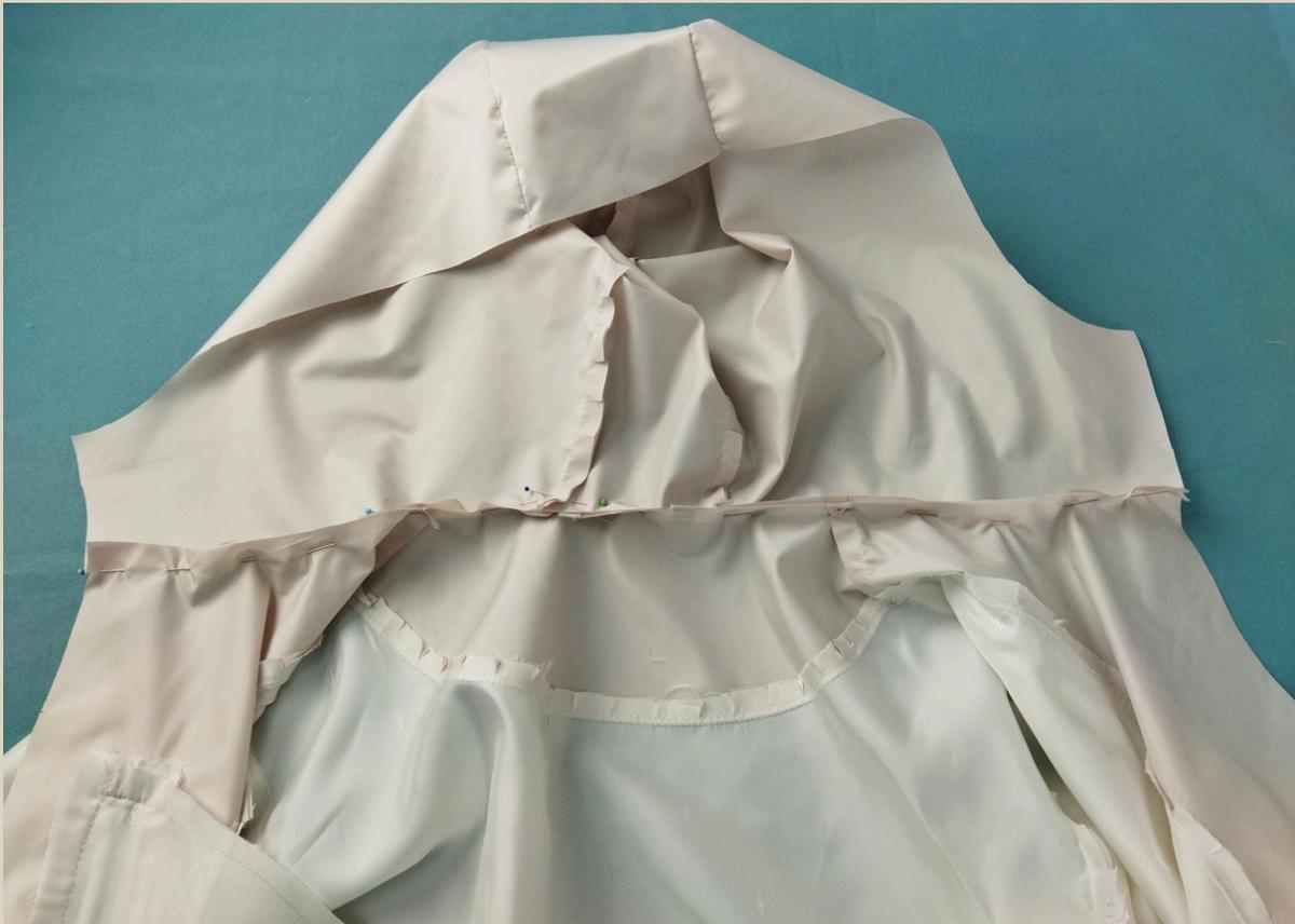
65. Внутренний капюшон вколоть булавками в горловину подкладки, совместить метки горловины и капюшона.
