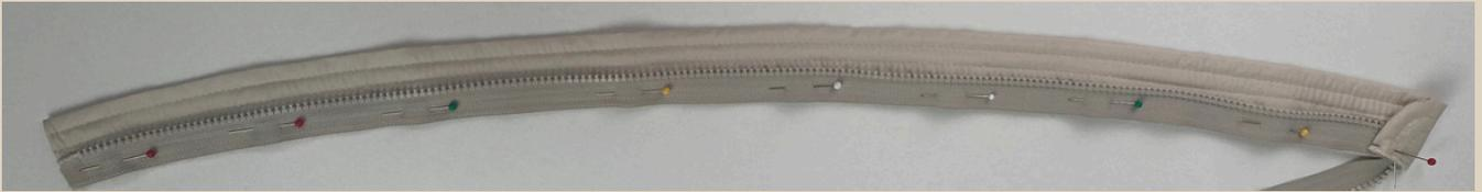
134. На ветрозащитную планку наколоть и настроить на швейной машине тесьму левой части молнии. Верх молнии обогнуть верхней частью планки.
