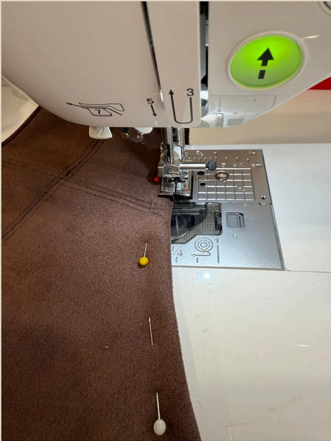
87. По краю ляжки проложить отделочную строчку на швейной машине. Ширина шва 1-2 мм.
