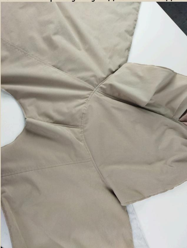
162. Припуск аккуратно заутюжить на сторону полочки и спинки и настрочить на швейной машине. Ширина шва 5 мм.
