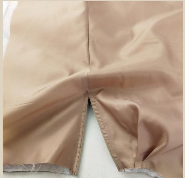
151. Отстрочить разрез на швейной машине. Ширина шва 5 мм.
