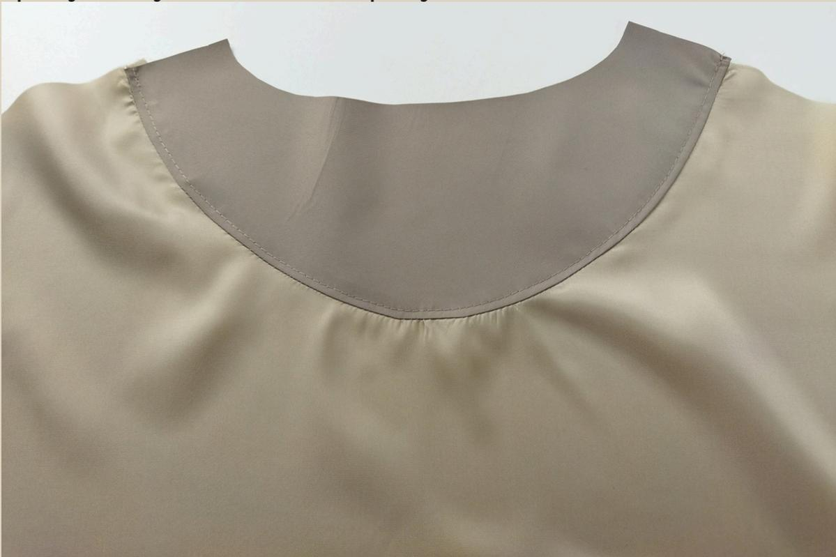
13. Настрочить припуск на сторону обтачки на швейной машине. Ширина шва 1-2 мм.
