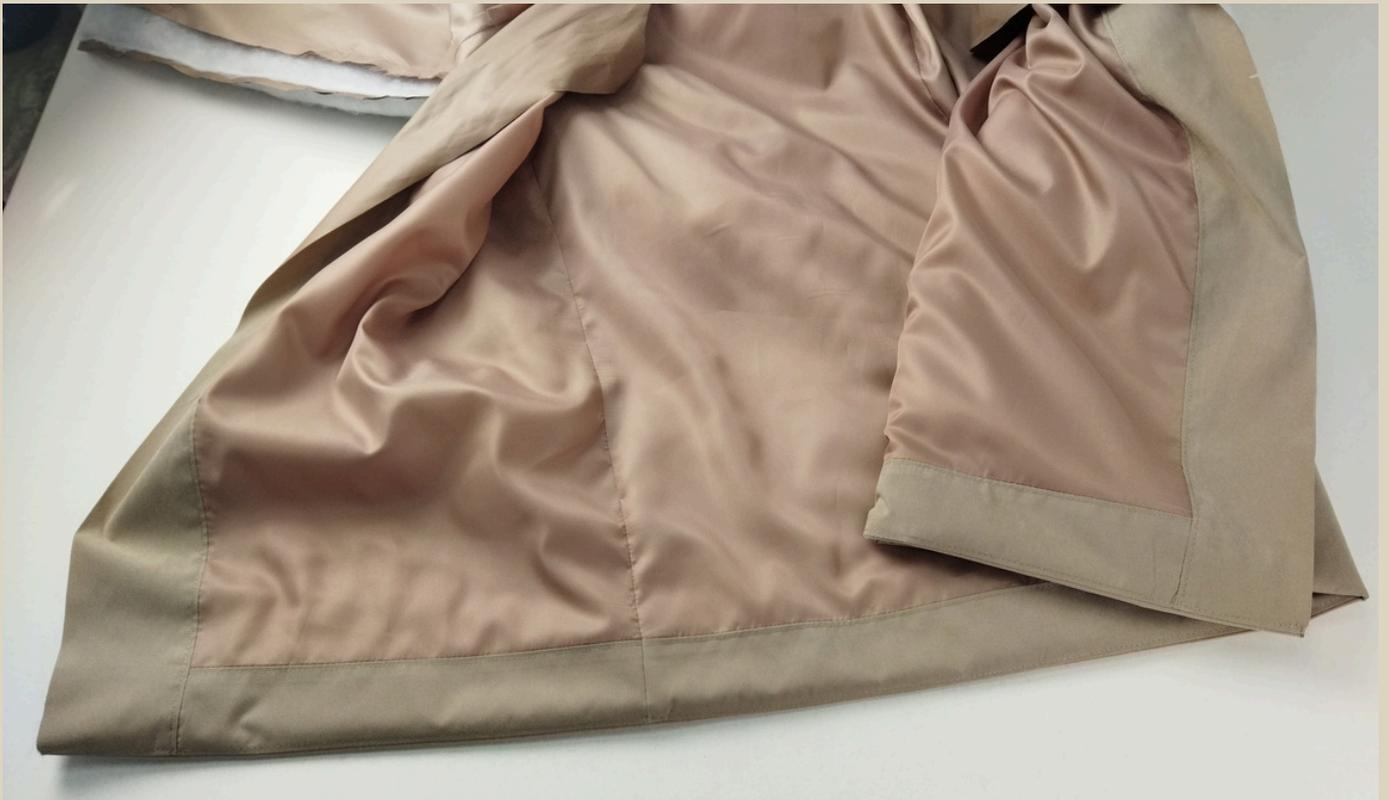
182. Припуск направить на сторону обтачки низа и настроить на швейной машине. Ширина шва 1-2 мм. Длина стежка 4 мм.
