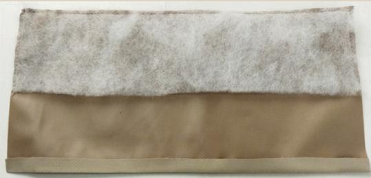
194. Припуск по длинной стороне без утеплителя заутюжить на изнаночную сторону на 9 мм.
