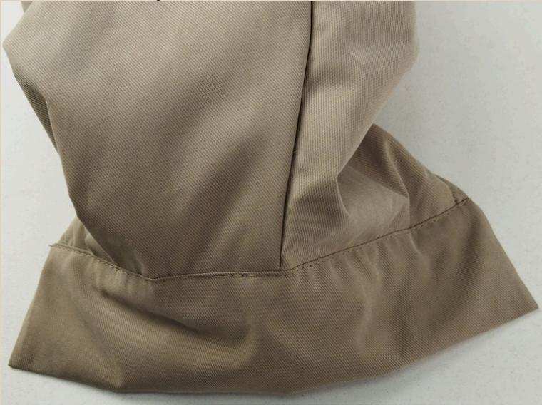
203. Проложить строчку на швейной машине. Ширина шва 1 мм.
