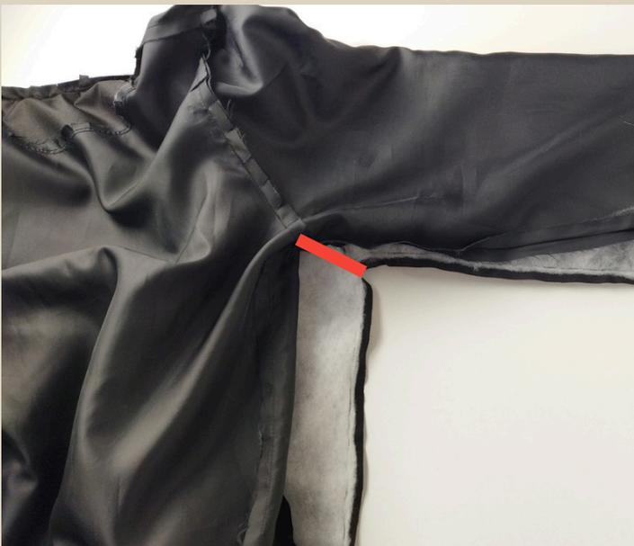
228. Куртку и подкладку закрепить между собой мостиками (полосками) из ткани (5 на 1 см) по низу проймы и по плечевому шву. Один конец мостика притачать к припуску куртки, второй к припуску подкладки.
