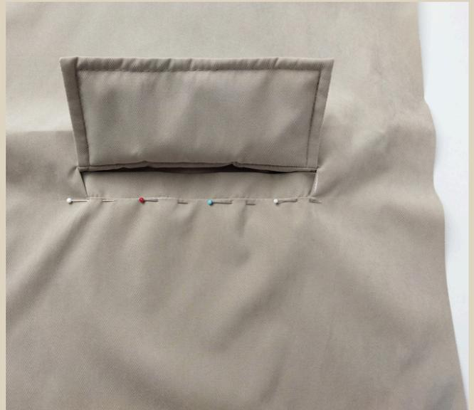
97. Мешковину отогнуть кверху детали, припуск по низу рамки приколоть булавками и настрочить его на швейной машине, строчку начать выше уголка на 1 мм и закончить на 1 мм ниже уголка.
