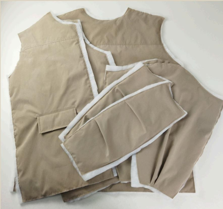
**113. Настрочить детали на утеплитель на швейной машине. Ширина шва 4-5 мм.**
