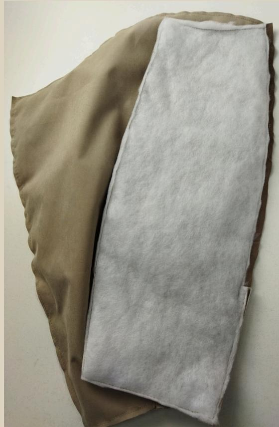
129. Стачать детали на швейной машине от оката до метки разреза.
