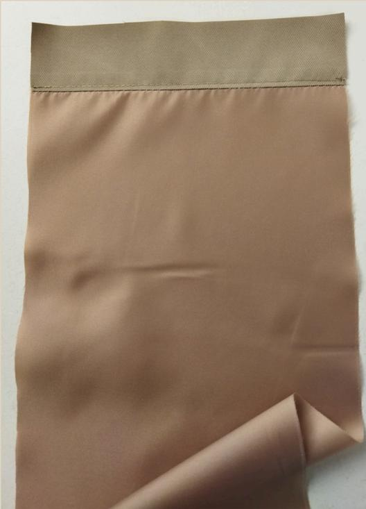
80. Припуск аккуратно заутюжить на сторону подзора и настрочить на швейной машине. Ширина шва 1-2 мм.
