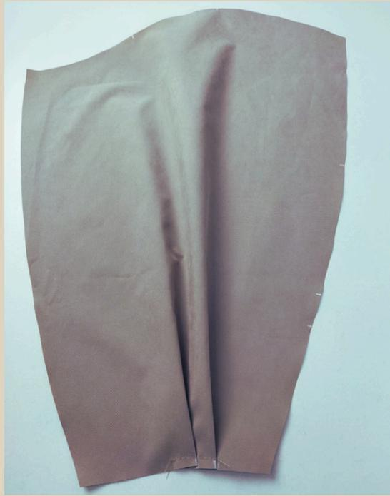
135. На передней части подкладки рукава по низу детали по меткам заложить 2 складки.
