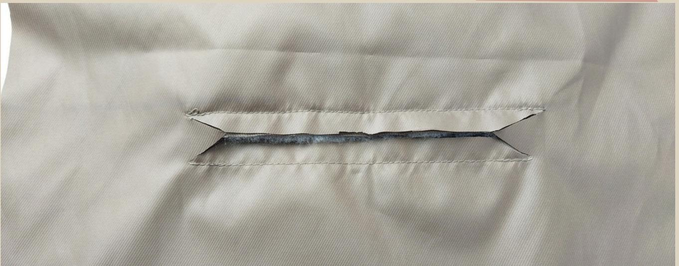
92. По изнаночной стороне по центру рамки по центру разрезать ножницами, не дорезая до коротких сторон рамки разрезы увести на уголки (края строчек), не дорезая до уголков 1-1,5 мм.
