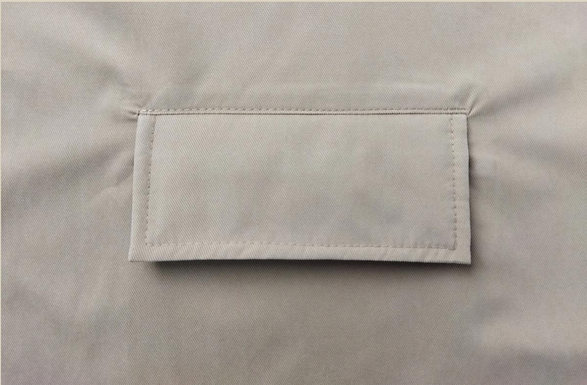
105. Верхний припуск кармана сколоть булавками и настрочить на швейной машине. Ширина шва 1 мм.
