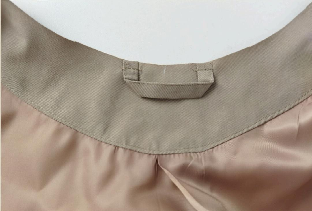
19. Настрочить вешалку на швейной машине. Ширина швов 5-7 мм.
