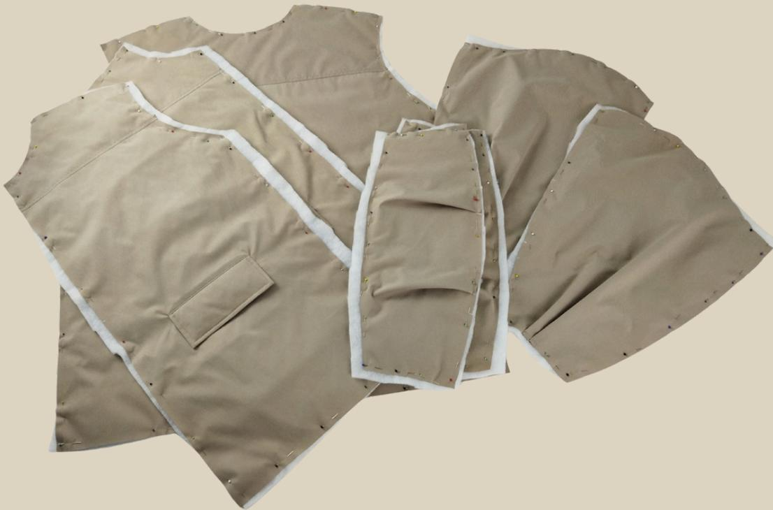
112. Детали из курточной ткани наложить на детали из утеплителя, наколоть детали булавками по припускам.
