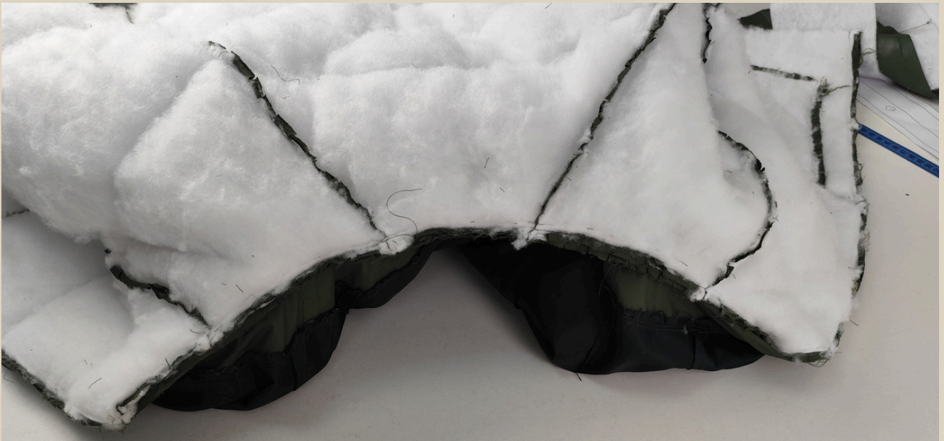
218. Утеплитель с припуска высечь.
