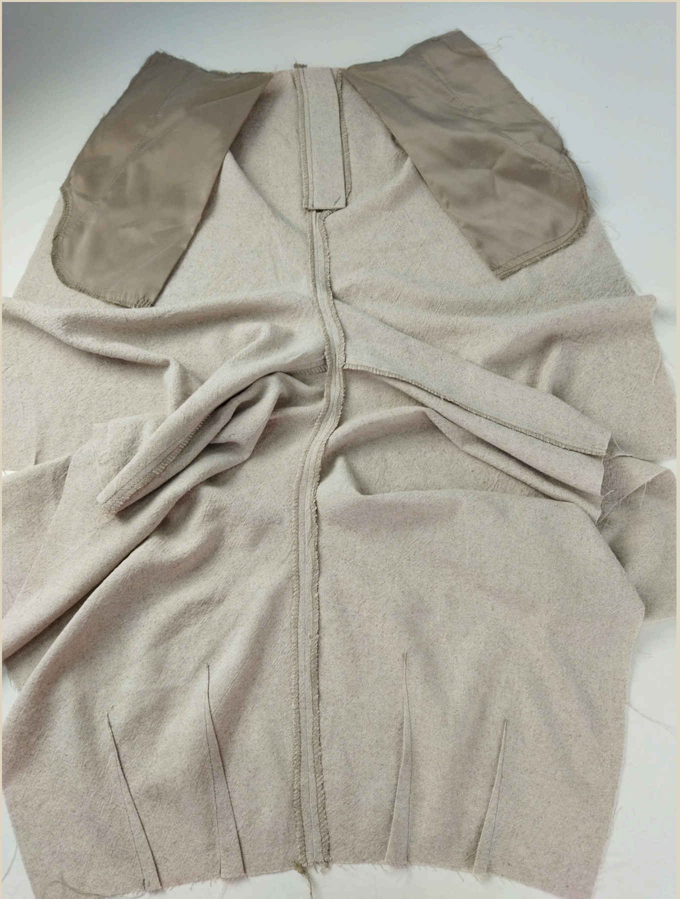
59. Припуск шва сидения разутюжить.
